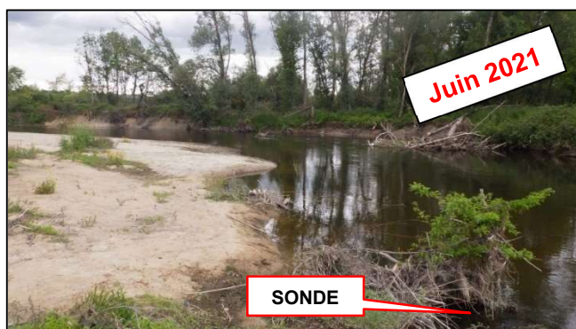
Figure 12 : Perte de données par ensablement de la sonde « confluence Allier »
